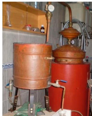
6. Alambique: recipiente de agua, caldera, tubo conductor, condensador.
